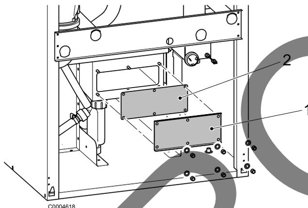
2. Soltar los tornillos y retirar la tapa (1) de la bandeja colectora de humos con la junta (2).
