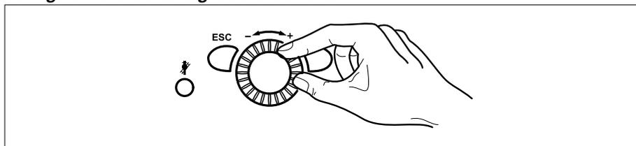
1. Ajustar el valor de consigna de confort mediante el mando giratorio => El sistema acepta el valor automáticamente
